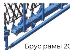
Крепление борон с помощью жёстких поводков
